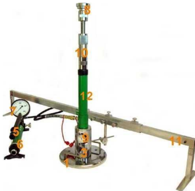
Rys. 1.2 Aparatura VSS z jednopunktowym pomiarem przemieszczenia płyty
